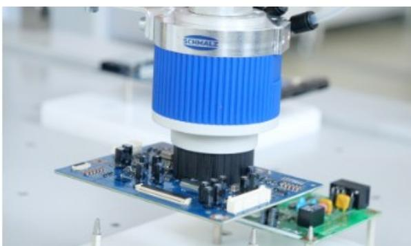
Der Strömungsgreifer mit der flexibel anpassbaren Stiftvorhang-Greiffläche dient zur Handhabung von Werkstücken mit stark strukturierten Oberflächen und empfindlichen bzw. sensiblen Bauteilen, wie z. B. bestückten Leiterplatten.
